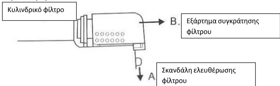
Αφαιρέστε το κύλιδρο και το συρμάτινο φίλτρο και το χάρτινο φίλτρο. Αφαιρέστε τα υπολείματα κόλλησης από το συρμάτινο φίλτρο. Καθαρίστε ή αντικαταστήστε το χάρτινο φίλτρο. Τοποθετήστε τα εκ νέου στον κύλινδρο με την σωστή σειρά και προσέχοντας το πλαστικό δακυλίδι συγκράτησης του συρμάτινου φίλτρου να εφαρμόζει σωστά.
